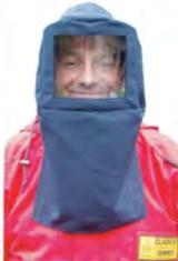
Gesichtsschutzhaube, royal/navy-blau, geprüft nach EN 166 + GS-ET-29 mit Doppeldreieck 1000 V und CE-Zeichen zur Verwendung als Störlichtbogenschutz, Schutzklasse 2 (7 kA / 0,5 s / LBP 318 kJ) zusätzl. gepr. LBP 395 kJ / ATPV 14 cal/cm<sup>2</sup> mit Nackenschutz / Schutzscheibe glasklar, royalblau / navyblau Best.-Nr. 7406960 EZT-Nr. 6506 9010 / DE / St. 0,45 kg
