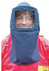
Elektriker-Schutzschirm mit Haube (Nomex), blau, geprüft nach EN 166 + GS-ET-29 mit Doppeldreieck 1000 V und CE-0340-Zeichen zur Verwendung als Störlichtbogenschutz, Schutzklasse 1 (4 kA / 0,5 s / 300 mm) Scheibengröße B x H 190 x 165 mm, glasklar, EZT-Nr. 6506 1080 / DE / St. 0,32 kg
