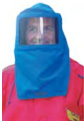
Elektriker-Schutzschirm mit Haube (Nomex), blau, geprüft nach EN 166 + GS-ET-29 mit Doppeldreieck 1000 V und CE-0340-Zeichen zur Verwendung als Störlichtbogenschutz, Schutzklasse 1 (4 kA / 0,5 s / 300 mm) Scheibengröße B x H 250 x 165 mm, glasklar, EZT-Nr. 6506 9010 / DE / St. 0,34 kg
